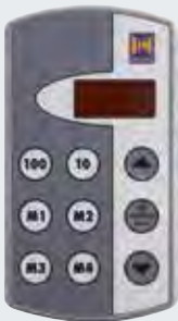
Industrie-Handsender HSI BS zur Ansteuerung von bis zu 1000 Toren, mit Anzeige-Display und extra große Kurzwahl-Tasten zur leichteren Bedienung mit Arbeitshandschuhen, Übertragung der Handsender-Codierungen auf weitere Geräte möglich
