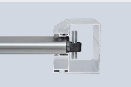
Rolltor DD Profil Decotherm S mit Stahl-Sturmhaken (ab 7500 mm Torbreite bzw. -höhe oder optional höherer Windlastanforderung)
